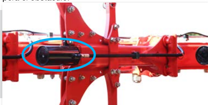
1 er y 4 o cuerpo con cilindros de diámetro sobradamente dimensionado.
